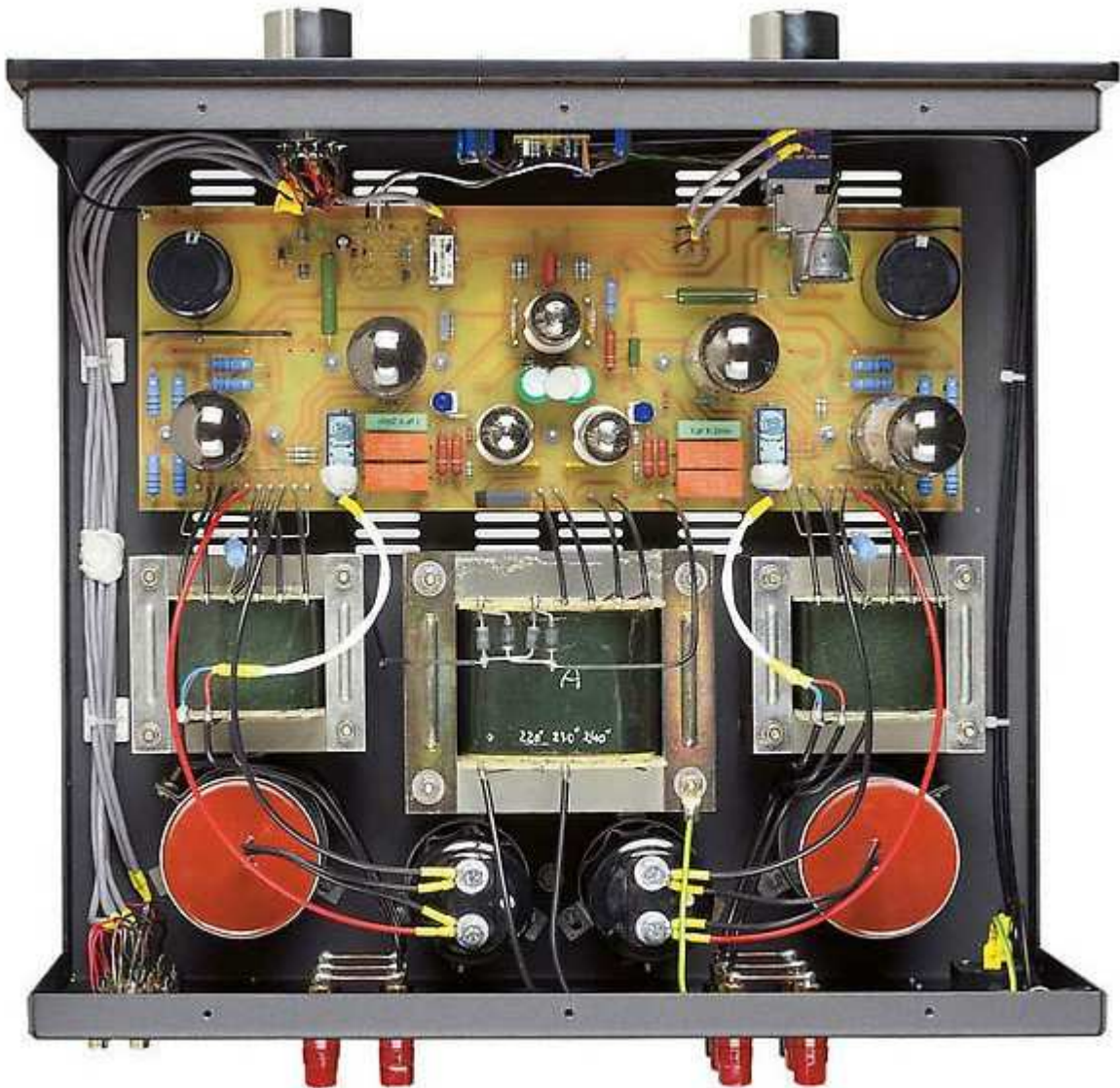
L'ARIA à cœur ouvert : 1 x ECC83S JJ Electronic pour l'étage d'entrée, 2 x ECC83S JJ Electronic pour l'étage Driver, et 4 x E34L JJ Electronic à polarisation automatique pour l'étage de sortie.
